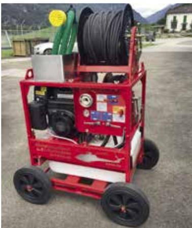
• Per la lotta specifica contro gli incendi causati da fulmine è stato fornito in forma sperimentale al corpo pompieri di montagna 3 Valli un modulo di spegnimento con pompa ad alta pressione. Questo modulo dispone di un serbatoio da 200l quale riserva d'acqua per il pronto impiego ed è stato reso elitrasportabile (con certificazione Swiss helicop-
