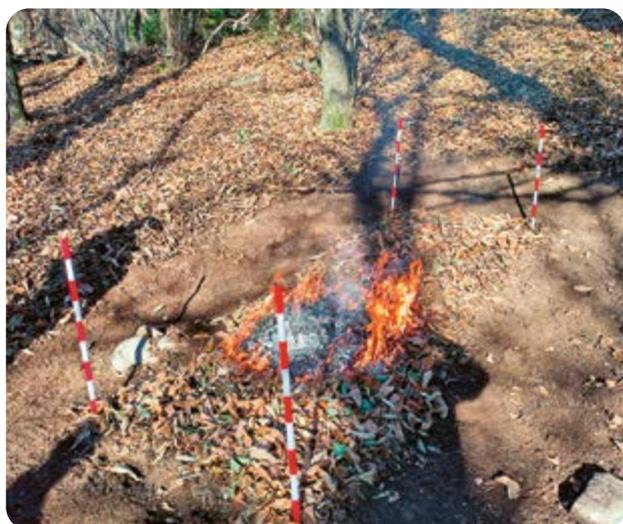
La previsione sull'infiammabilità dei combustibili forestali elaborata tramite indici specifici è verificata e analizzata sul terreno tramite dei fuochi di prova eseguiti dal personale del GIB secondo un protocollo standardizzato. Questo permette al personale forestale di acquisire importanti conoscenze pratiche sull'interazione tra meteorologia e combustibili forestali (Monti di Cresciano, 2024).
